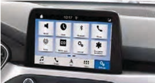
Допирен екран од 8 инчи со повеќе функции Прикажува телефонски, аудио, навигациски (кога тоа ќе биде наведено) и мобилни апликации, со функционалност на листање и зголемување/намалување со два прста, како и шест звучници. (стандардно за Trend Edition Business, ST-Line Business, Titanium и Titanium Business)
