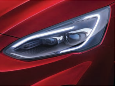
Системот со приспособливо предно осветлување (на англ. Adaptive Front lighting System) со динамични предни LED-светла, долги светла кои не предизвикуваат блесок и секвенцијални LED-трепкачи (опционално за Trend Edition Business и Titanium Business)
