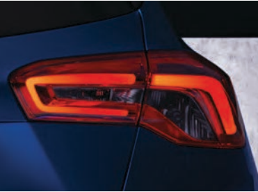
LED/халогени светла Задните LED/халогени светла се со интегрираната препознатлива лента со LED-светла, која светнува кога ќе се вклучат предните светла. (задните LED-светла се опционални за сите серии)
