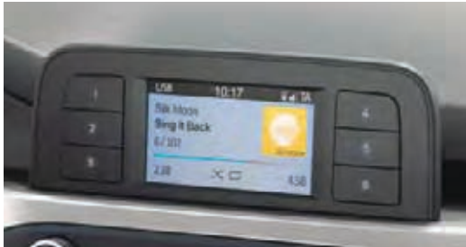
Екран од 4,2 инчи Стандардно со поврзано радио. Аудиосистемот може да се контролира со помош на Voice Pass преку одликата со гласовно активирање на компатибилен телефон. (стандардно за Trend)
